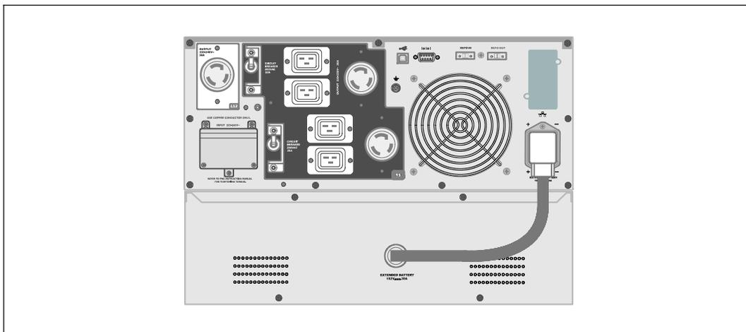
**7** 將 EBM 電纜插入 UPS 電池接頭。
