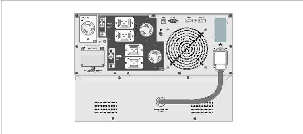
**7** Enchufe el cable del EBM en el conector de la batería de la UPS.
