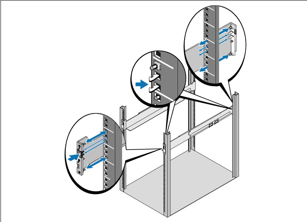
**✍ Примечание:** Инструкции по работе со стойками с квадратными отверстиями и стойками с круглыми безрезьбовыми отверстиями являются одинаковыми. Направляющие подходят для обоих видов стоек. Круглый блок показан на рисунке.
