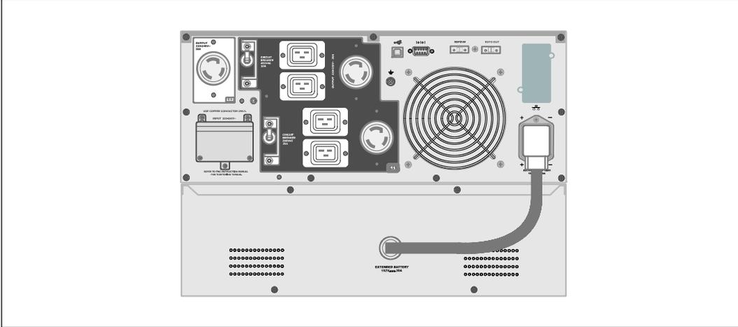
**7** 将EBM电缆插入 UPS 电池连接器。
