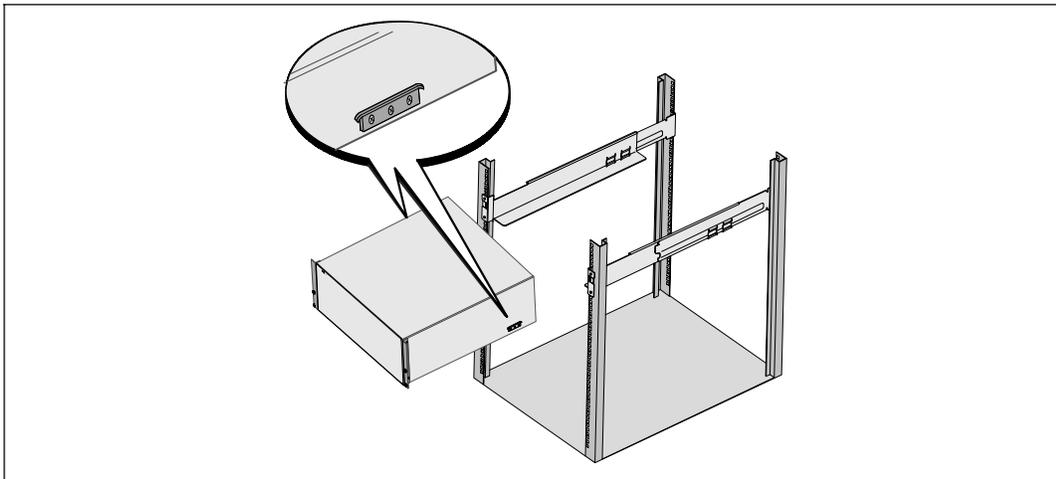
**4** Schieben Sie das Gehäuse in das Rack.
