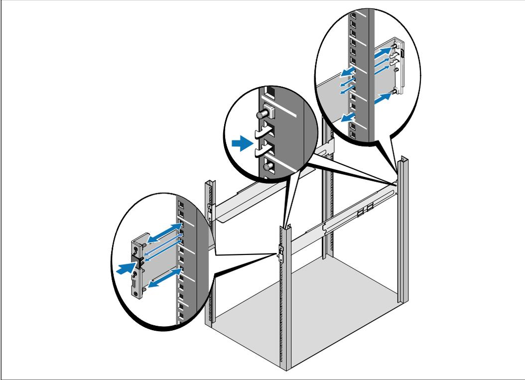
**참고:** 사각 구멍 랙과 나사산 없는 원형 구멍 랙에 대해 설치 지침은 동일합니다. 레일은 두 종류의 랙에 모두 맞습니다. 원형 구멍 랙은 그림에서 볼 수 있습니다.
